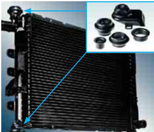
ラジエタ - マウント Radiator suspension 上部 : VESTORAN/EPDM 下部 : VESTORAN/NR+SBR
